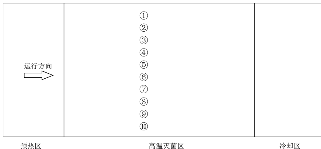
图 1 温度测量标准放置位置示意图
